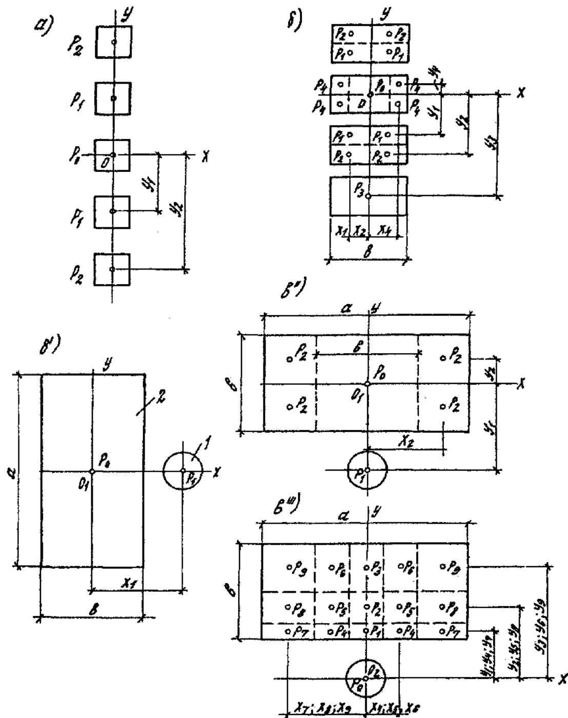
*a* – нечетное число одинаковых нагрузок, расположенных в один ряд; *б* – то же, при четном числе нагрузок  $b \leq 4,4l$ ; *в' (в''; в''')* – нагрузка разной величины с различными площадями следов; 1 – след колеса транспортного средства; 2 – след станка, агрегата
