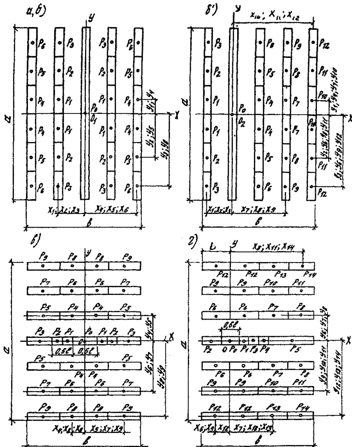
*a, в – нагрузки, равномерно распределенные по длине параллельных следов (от прокладок под тяжелые предметы, от штабелей цилиндрических валов и др.) при  $b \leq 4,4l$ ;  $a > b$ ; б, б' – то же, при  $b > 4,4l$ ;  $a > b$*
